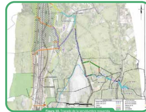
Figura 10. Trazado de la servidumbre requerida.
